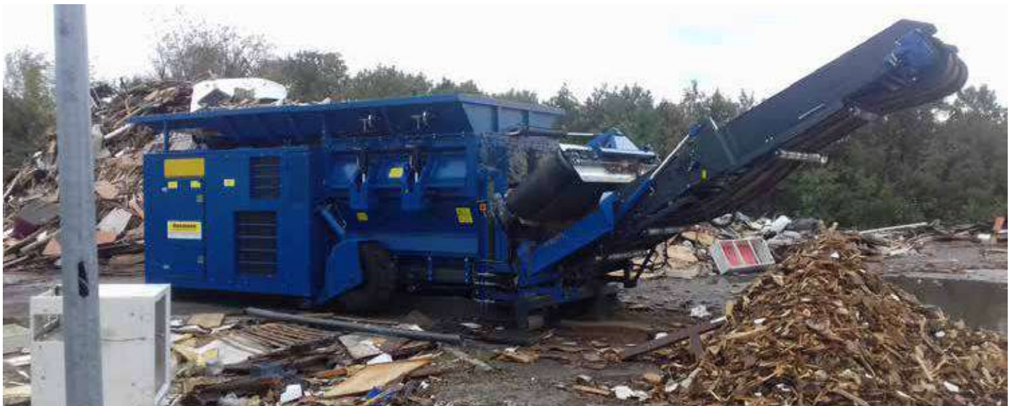
Drveni otpad usitnjava se specijalnim strojevima
