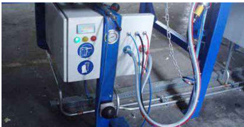
Uređaj za sigurno uklanjanje freona iz sustava za hlađenje. BEZ OVOG UREĐAJA, POSTUPAK RASTAVLJANJA SUSTAVA ZA HLAĐENJE JE OPASAN ZA ZDRAVLJE I ŠTETAN ZA OKOLIŠ!
