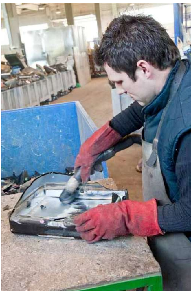
Odstranjivanje fosfora s unutarnje stjenke tv ekrana
