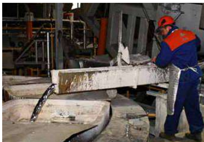
Ispuštanje lijeva iz peći
